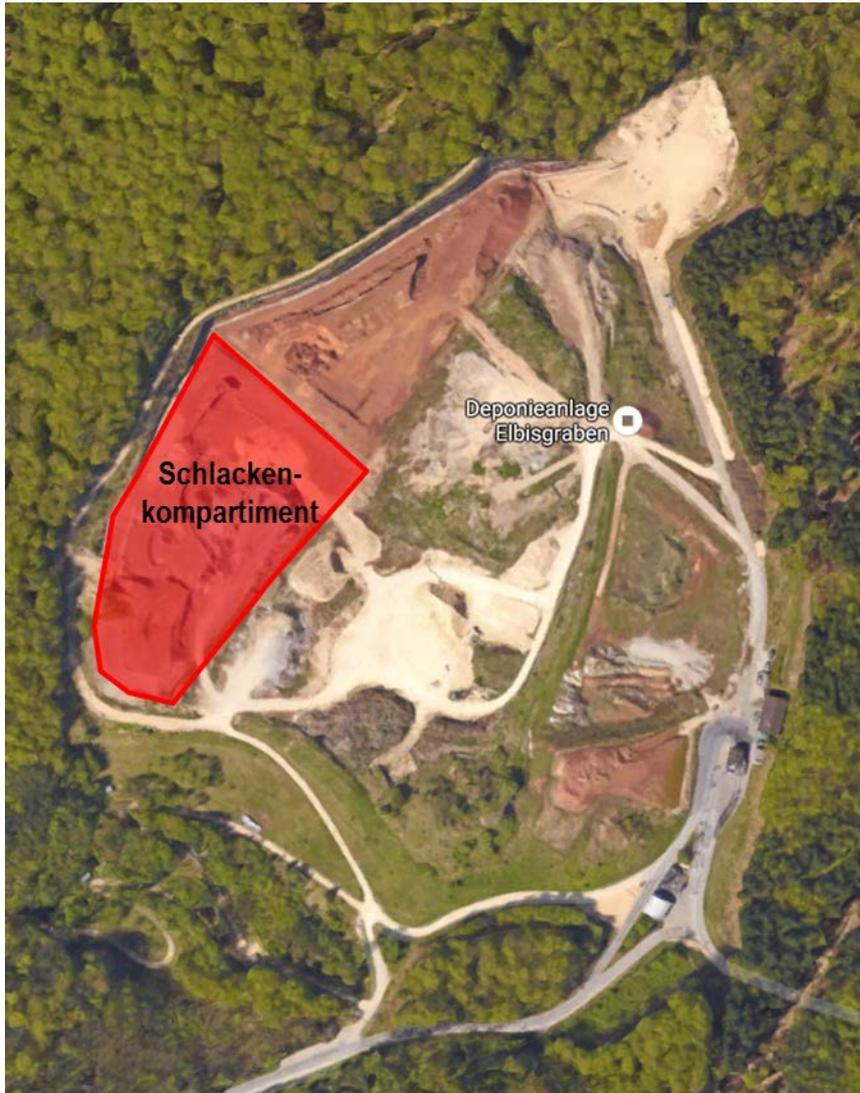
Abb.1: Schlackenkompartiment der Deponie Elbisgraben zur Einlagerung von KVA-Schlacke (Luftaufnahme).
