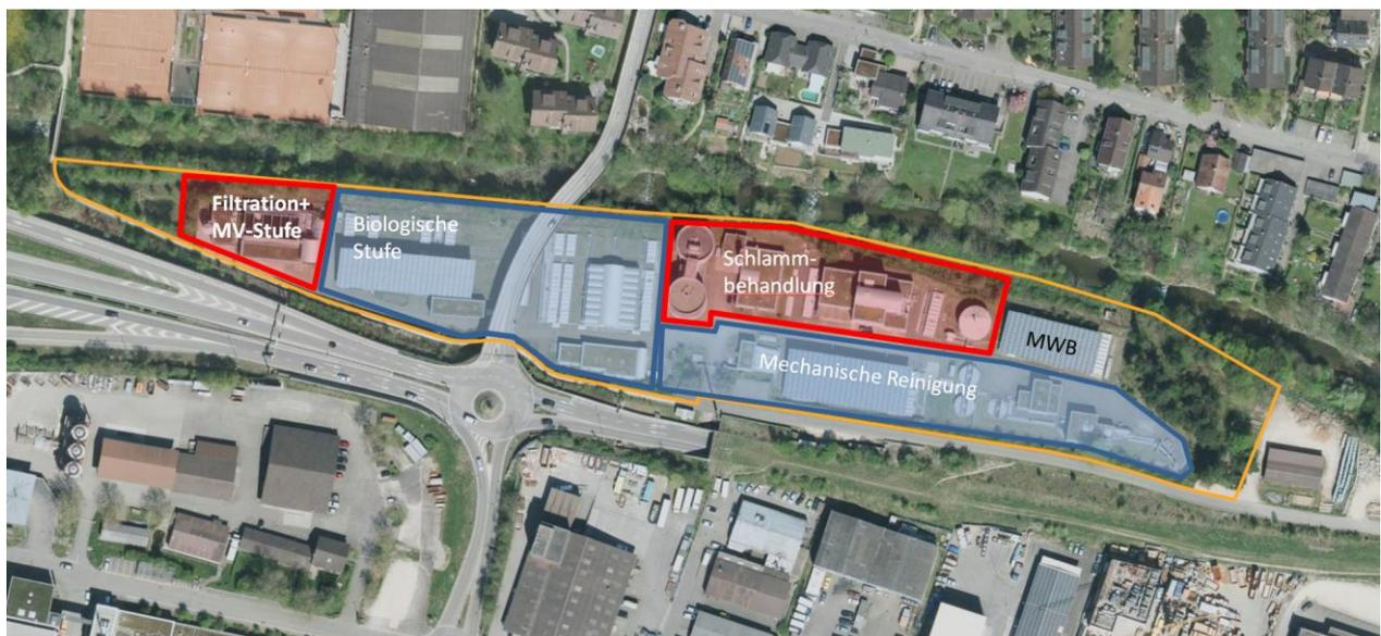
Abb. 3: Projektperimeter: Filtration inklusive MV-Stufe und Schlammbehandlung (rot). Die mechanische und biologische Reinigung (blau) ist nicht Bestandteil dieser LRV (separate LRV 2020/2021 geplant). Für das Mischwasserbecken (MWB) sind derzeit keine Massnahmen vorgesehen.
