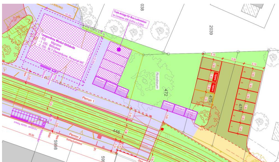
Abb. 6: Bereich nördlich von Bushof mit temporärem Modul-Gebäude (Provisorium), Veloabstellplätzen, Trafo-Anlage für Bus-Ladestation sowie Ersatzparkplätzen (technischer Situationsplan).
