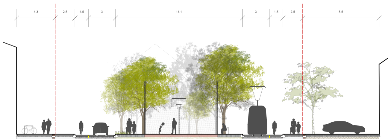
Abbildung 3 Normalprofil Binnerstrasse (Zweispurbetrieb) mit durchgehendem Radstreifen
