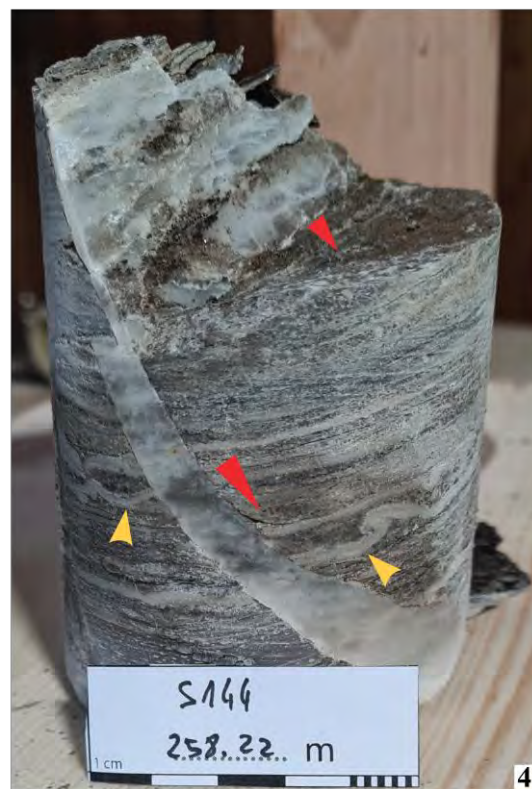
Abb. 107: (1) Orientierung des Bohrkerns im Kernständer relativ zur geographischen Nordrichtung für die kinematische Analyse. (2) Überschiebung mit Rutschharnisch und Tonfilm, (3) dextrale Blattverschiebung mit Gips Mineralisation sowie (4) Abschiebung mit sichtbaren Schichtversatz und Gipsfüllung (gelbe Pfeile). Der Schersinn ist mit roten Pfeilen markiert.
