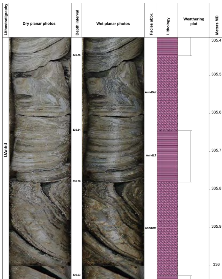
Abb. 119: Anhydrit deformiert (AnhdDef) und laminiert (AnhdLT) im Bohrkern der S 150 Die deformierten Bereiche sind auf Verfaltung und Schichtschleppung zurückzuführen.
