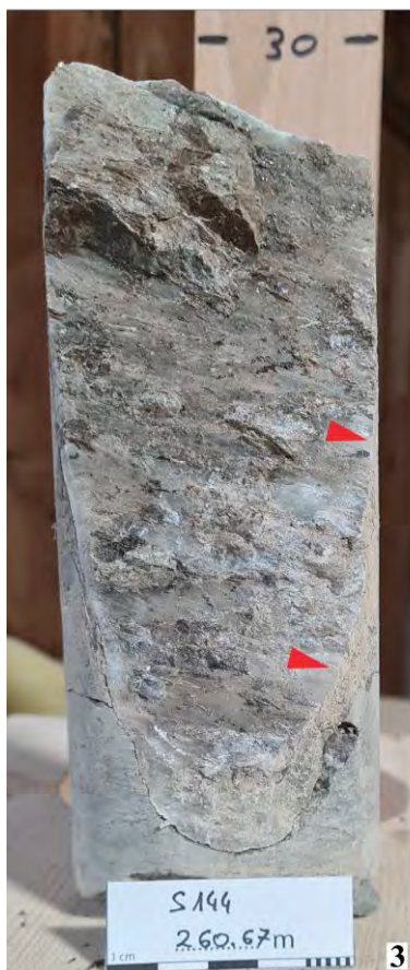
Abb. 107: (1) Orientierung des Bohrkerns im Kernständer relativ zur geographischen Nordrichtung für die kinematische Analyse. (2) Überschiebung mit Rutschharnisch und Tonfilm, (3) dextrale Blattverschiebung mit Gips Mineralisation sowie (4) Abschiebung mit sichtbaren Schichtversatz und Gipsfüllung (gelbe Pfeile). Der Schersinn ist mit roten Pfeilen markiert.
