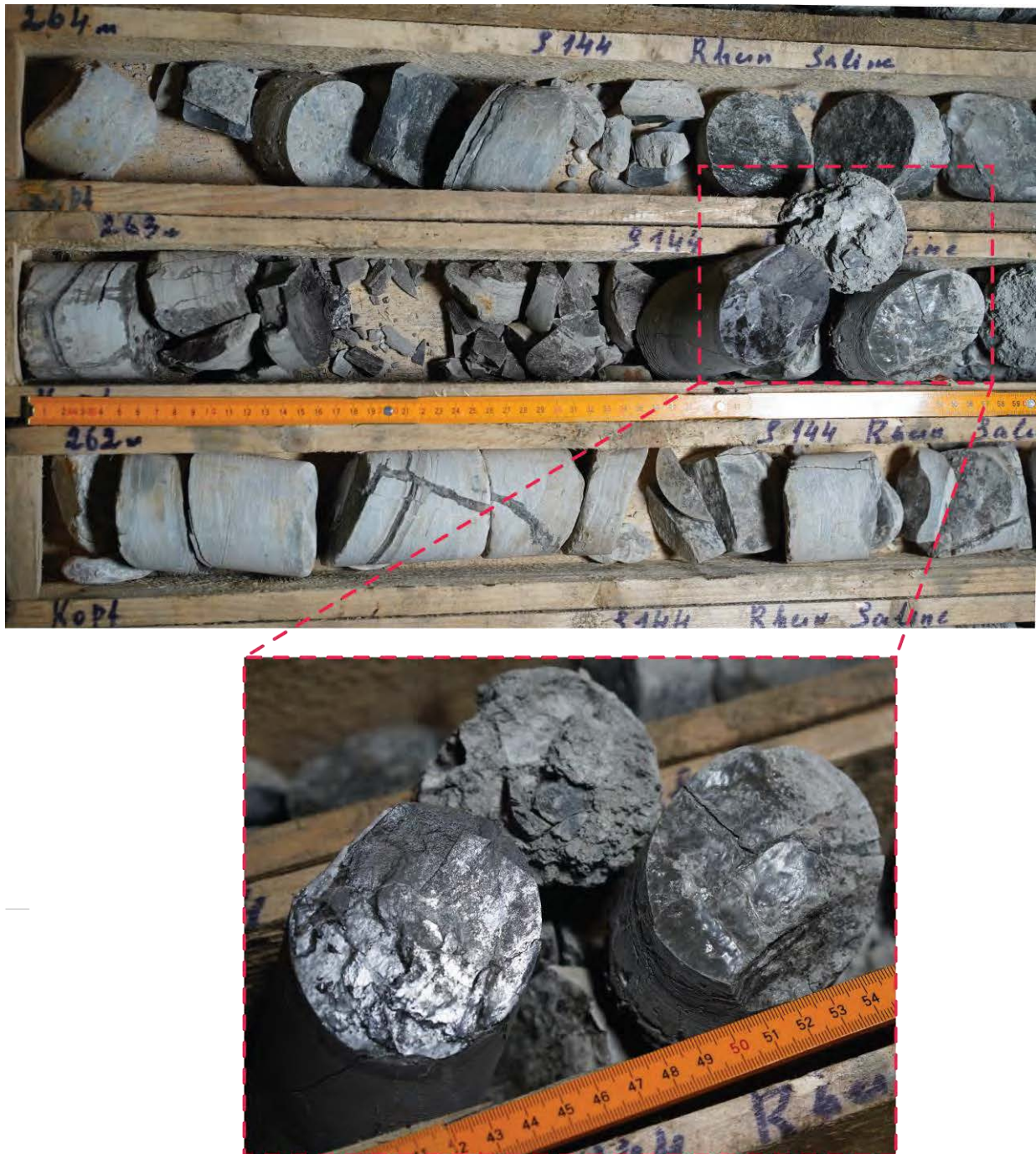
Abb. 45: Teilbereich der spröden Scherzone in Übergangsschichten zwischen 262.00 und 264.60 m. Diese insgesamt 21.41 m mächtige Bruchzone (250.84 – 272.25 m) ist durch teilweise vollständig inkohärente und kataklastische Bohrkerne repräsentiert. Die zahlreichen Schichtparallelen Störungsflächen und Kernbruchstücke sind üblicherweise mit Spiegelharnischen assoziiert.
