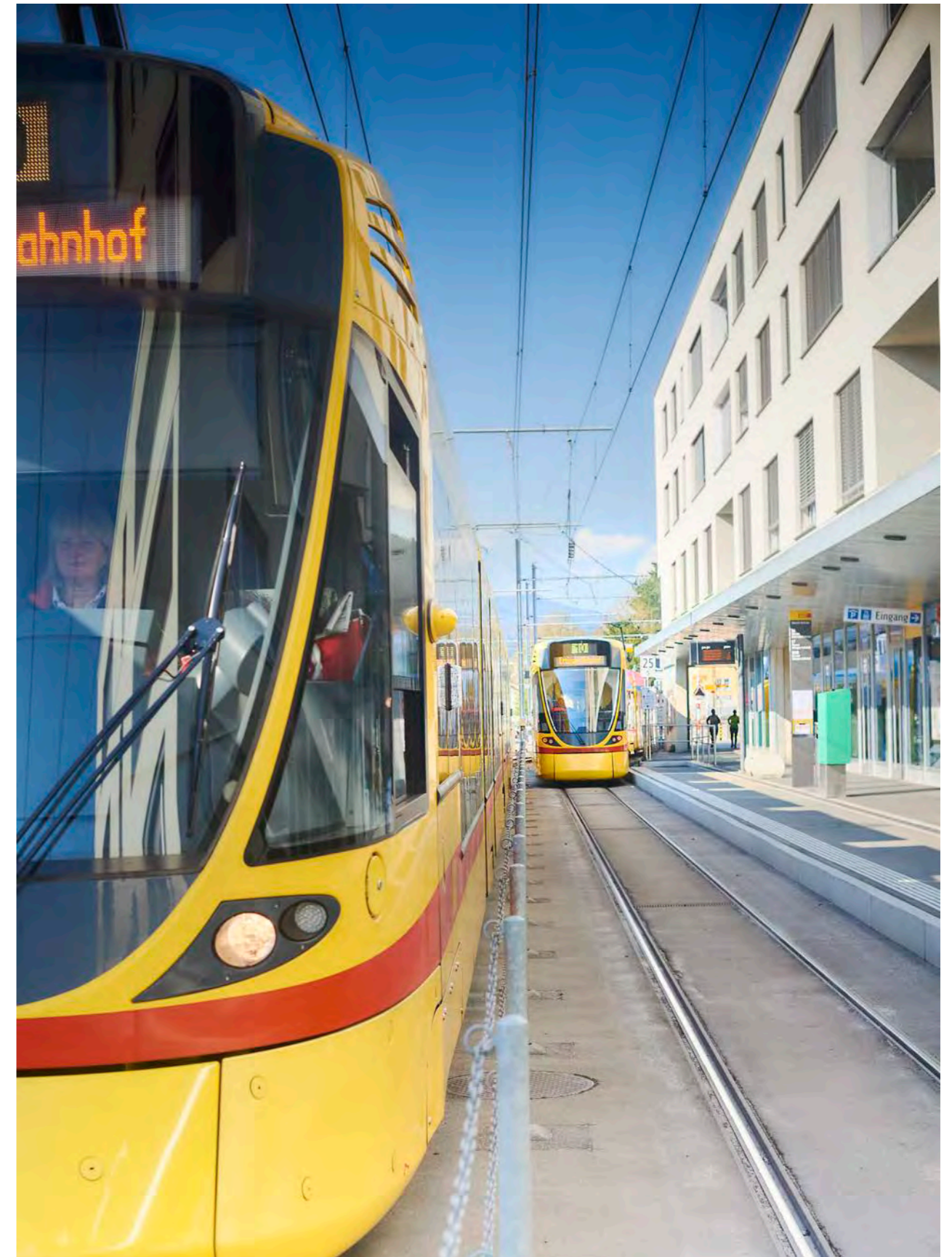
Mit innovativen Lösungen die Energieeffizienz erhöhen: Die Bremsenergie der Trams wird in Schwungmassenspeicher geleitet und wiederverwendet.
