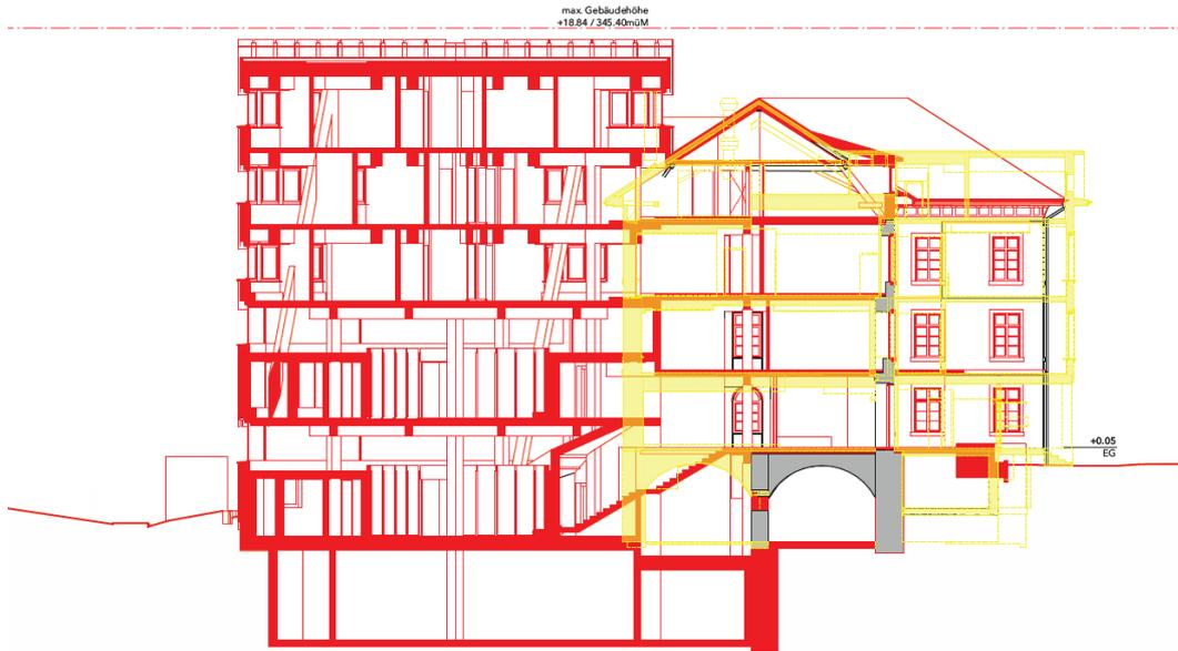
Schnitt durch Bestand und Erweiterung (Bestand grau, Abbruch gelb, Neubau rot)
