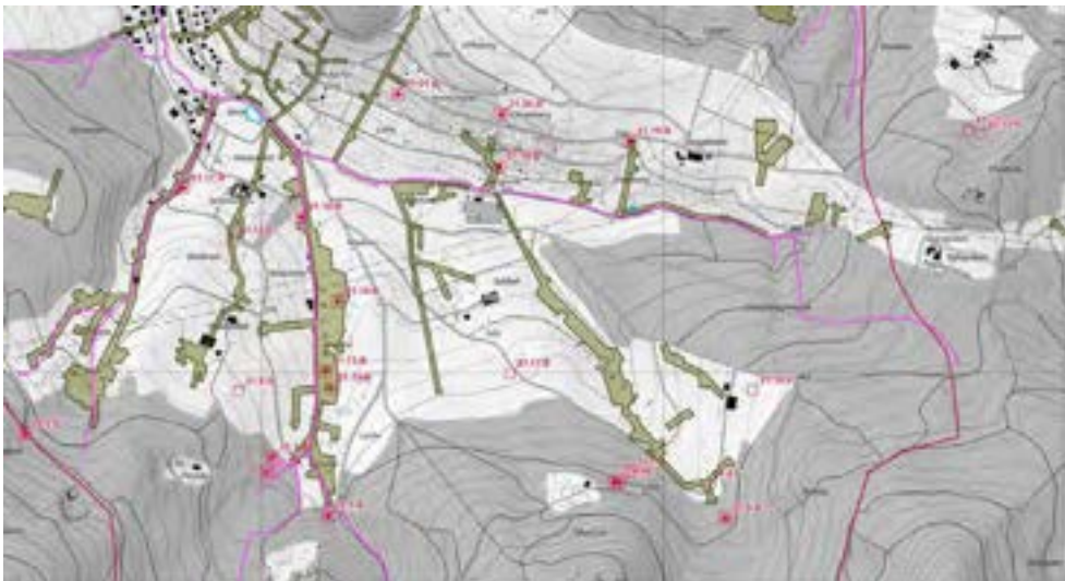
Abbildung 19: Gewässernetz (violett), Drainageflächen (braun) und Quellen (rot) im Gebiet Sulz und GZB (Quelle: GeoView BL).
