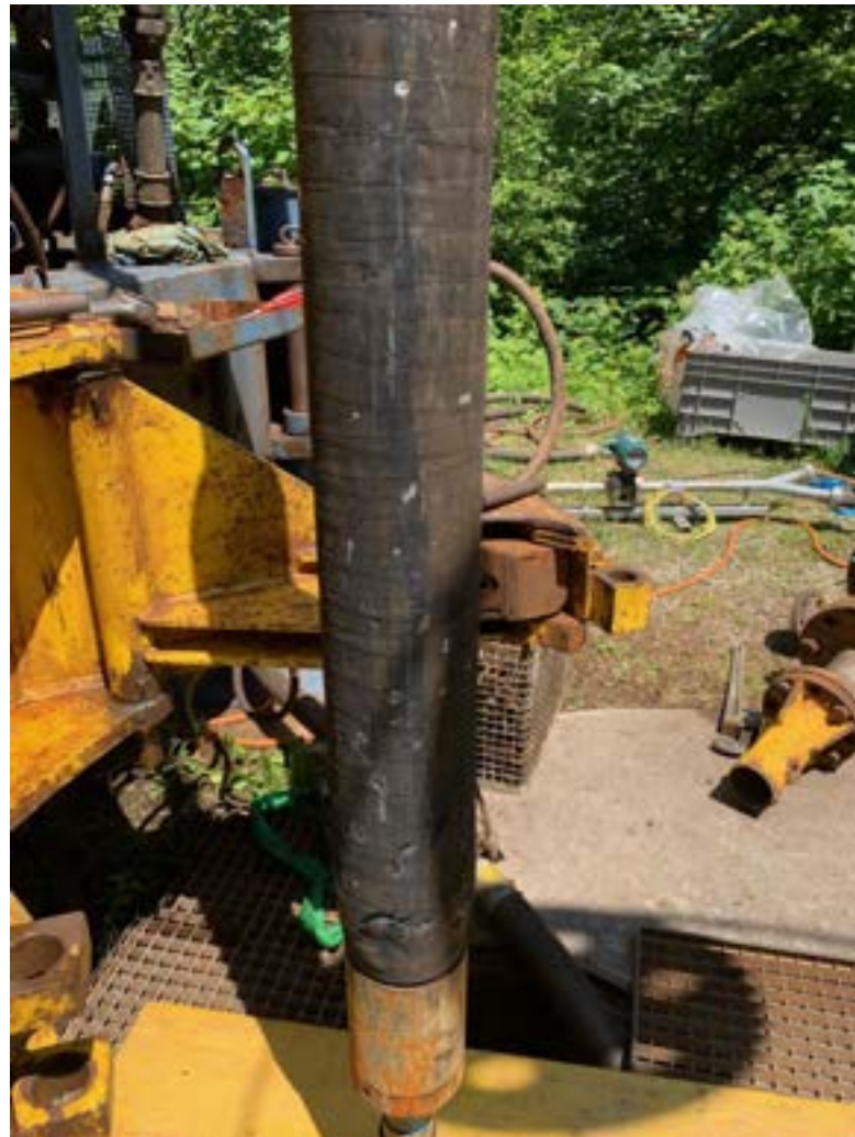
Abbildung 3.3.2: Sehr schwere Beschädigung der Packermanschette aufgrund scharfkantiger Bohrlochwand
