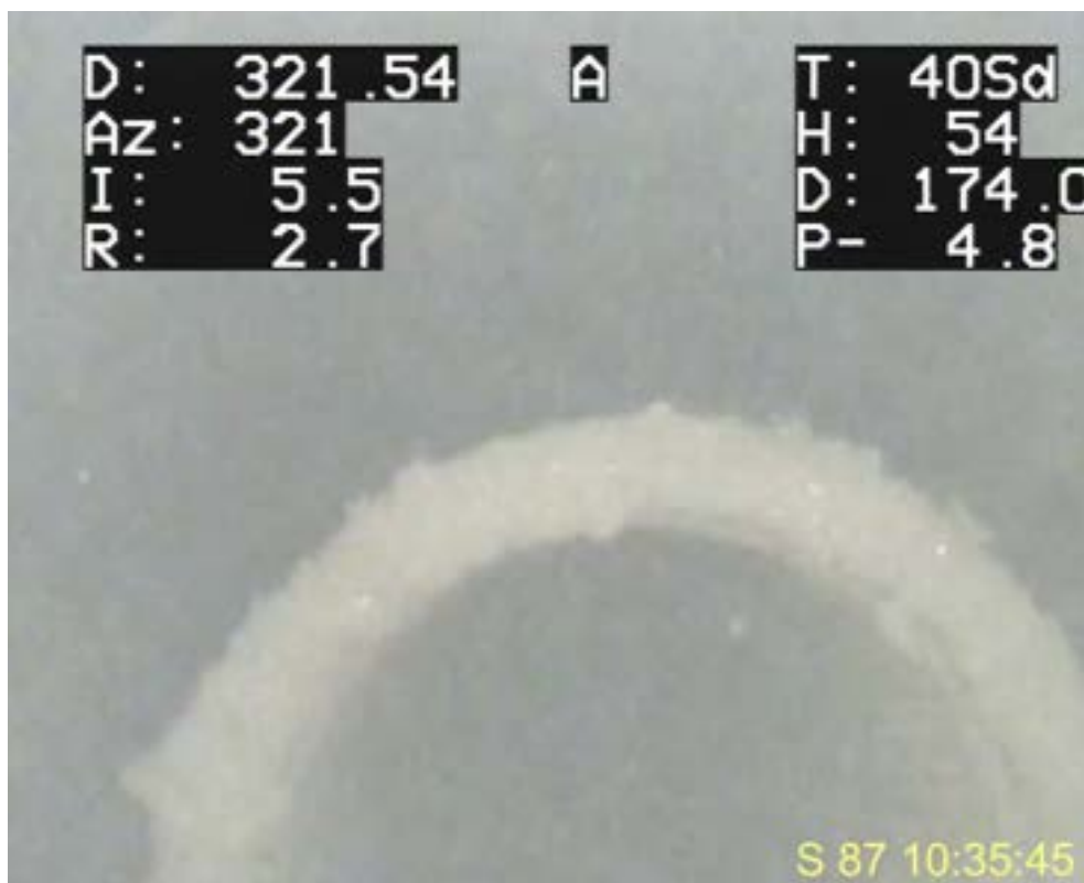
Abbildung 14: 4"-Rohrstück in 8" Casing des Bohrlochs S87, Blick nach unten.
