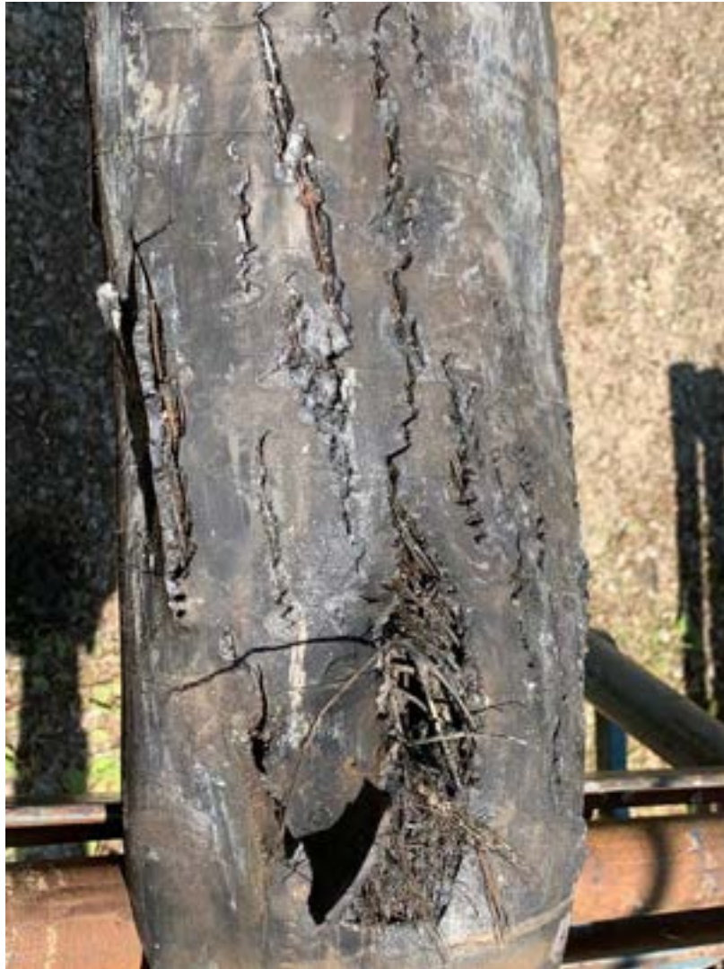
Abbildung 3.3.1: Überdehnung der Packermanschette führte zur vollständigen Zerstörung
