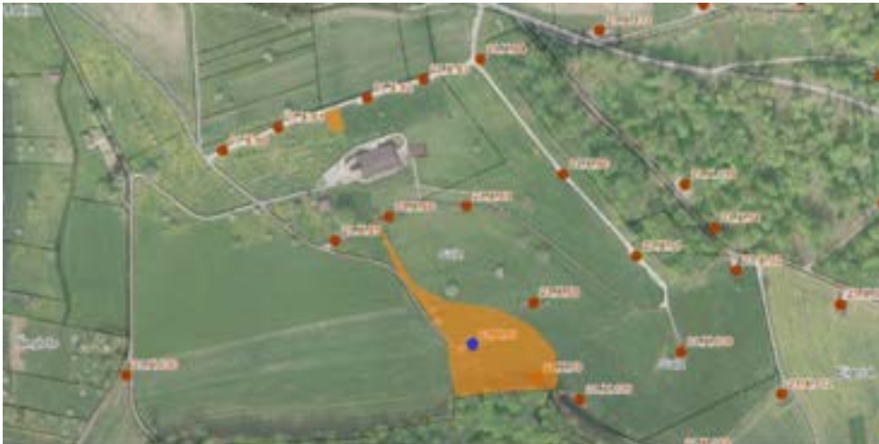
Abbildung 10: Abgrenzung des sichtbar geschädigten Bereichs (orange Fläche) gemäss BBB [13], die Sanierungsfläche beschränkte sich auf das Gebiet östlich des Sulz-Eigentalswegs sowie die Erosionsrinne nördlich des Sulzhofs; Abbildung: Vogt Planer.
