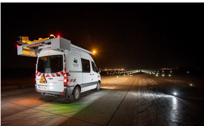
Innovation trotz Krise: Pistenanalyse mit Lasersensoren
