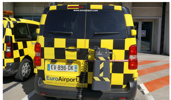
Neues System auf den Pistenfahrzeugen zur Analyse von Verunreinigungen
