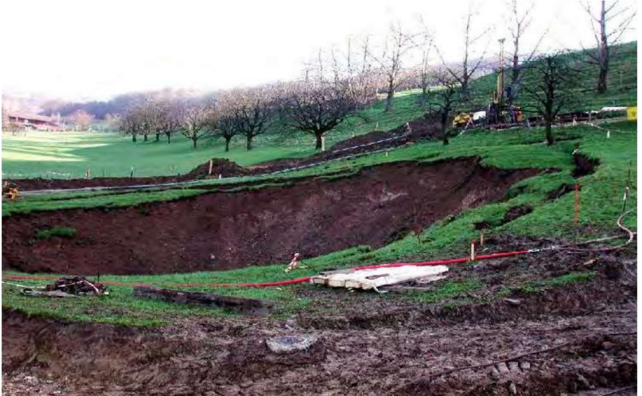
Abbildung 3: Tagbruch vom 1. Februar 2002 - Trichter an der Oberfläche.
