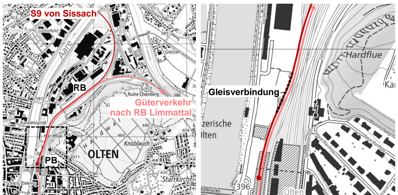
Abbildung: Geforderte, parallele Einfahrmöglichkeit für die S9 mit neuer Gleisverbindung
