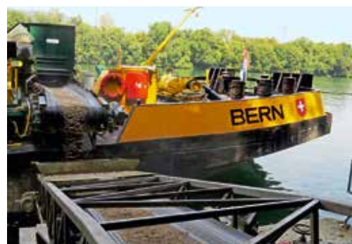
Nachhaltige Selbstentladevorrichtung über Förderbänder der MS Bern
