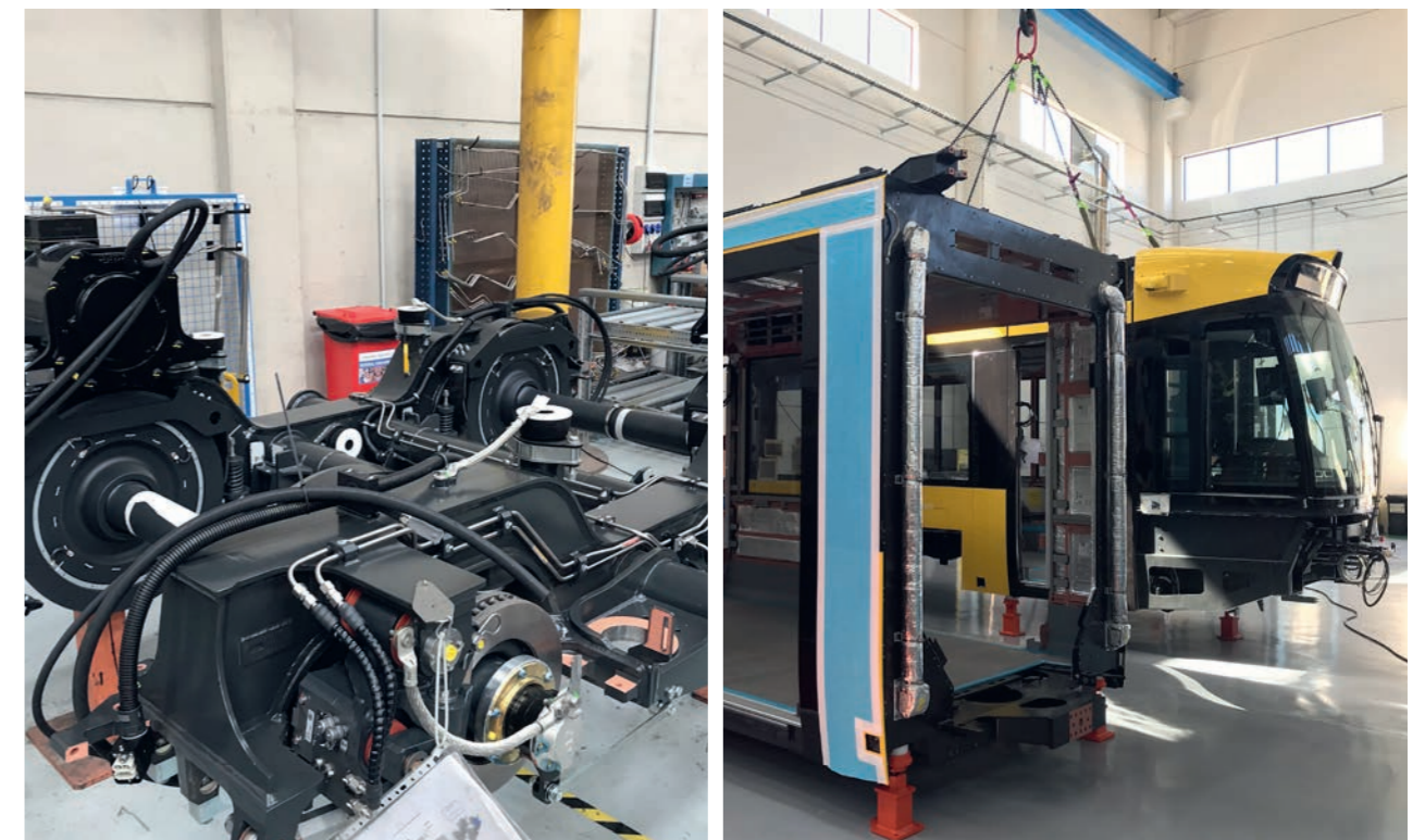
Der erste BLT Tramlink in Produktion – mit einem Fahrwerk auf dem Prüfstand (links) und Wagenteilen in der Endmontage (rechts).
