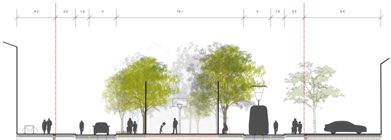
Abbildung 3 Normalprofil Binningerstrasse (Zweispurbetrieb) mit durchgehendem Radstreifen
