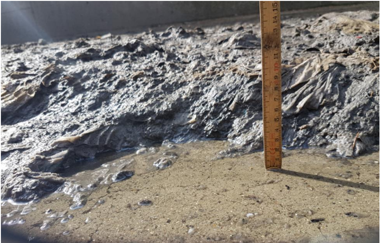
Abb. 1: Aufgefangener Schmutzstoss im Mischwasserbecken Heideweg, Reinach am 03.04.2017.
