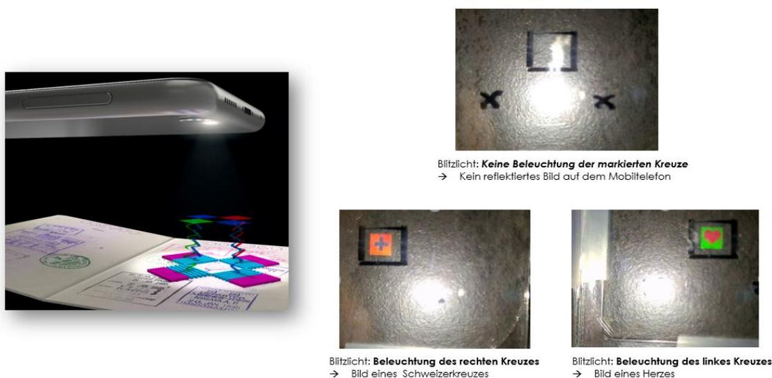
*Figur 3: Mobiltelefon-lesbares Sicherheitselement, das mit Kamera und Blitzlicht identifiziert werden kann.*
