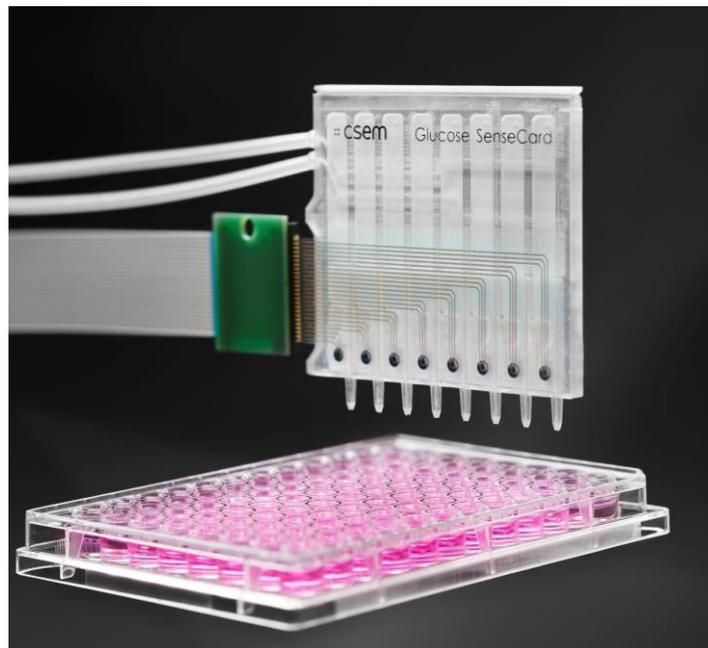
*Figur 10: Parallelisierte Glukose-Sensorkarte für die Laborautomation*
