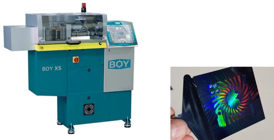
Figur 13. Spritzgussmaschine für die Prototypenherstellung von nanostrukturierten Kunststoffteilen
