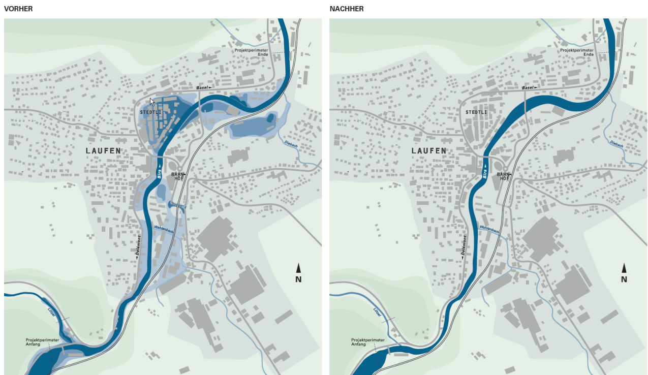
Links die aktuelle Gefährdung bei einem Hochwasser (HQ 100 ) wie jenem vom 2007. Rechts die Situation eines Hochwassers HQ 100 nach der Umsetzung des Hochwasserschutz-Projekts Laufen.
